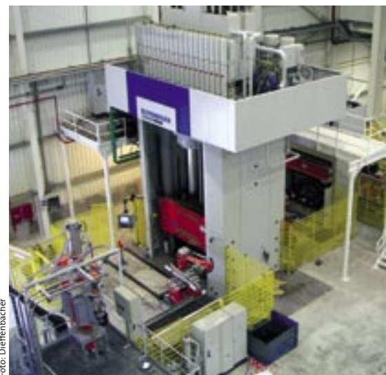
Die Aufgabenstellung: LFT-D Pressanlage zur Herstellung von faserverstärkten Kunststoff-Pressteilen
