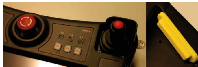
Bild 3: Bediengerät: Front und Rückseite mit Zustimm- oder Tipp-Taster.
